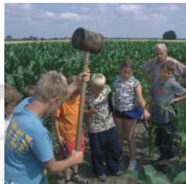
Zur Entnahme von Bodenproben muss erstmal ein Bohrstock eingeschlagen werden.
